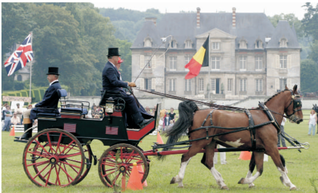
Elegant ekvipage. Forreste fjedre bør bankes op. Beslag, lamper og spænder bør være af ens metal. Cuts 2003.
