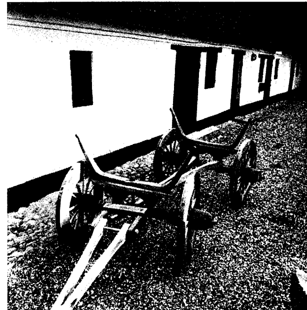
Fig. 10. Vognen uden vognkasse. Bemærk de krumvoksede kæppe, tvejede vognstang og kløftede langvognsbom. Foto: P. Dehlholm.
