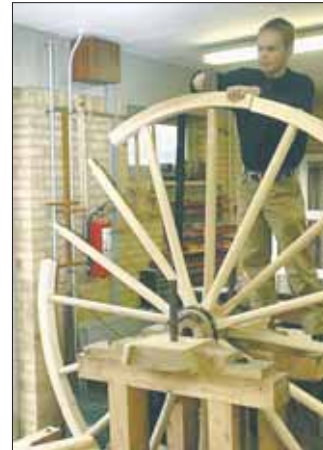
I læretiden har Ole Jespersen blandt andet lavet to meget store hjul til Brønderslevs gamle hestetrukne brandstige. Hjulenes diameter er 215 cm. Her sætter karetmagerlærlingen fælg på et af hjulene.
