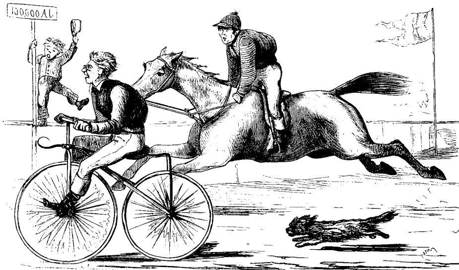
På billedet, fra Illustreret Tidende 1869, ser man en hr Velocipedersen vinde Damernes Pris ved i et væddeløb at besejre »en berømt tiårs vallak«. De første velocipeder, som kom til Danmark, havde ret stor lighed med nutidens cykler, men pedalerne var anbragt direkte på forhjulsakslen, og det krævede et voldsomt benarbejde at holde maskinen i fart. Problemet løstes senere ved at gøre forhjulet kæmpestort, den udgave alle kender; det sparede på kræfterne, men havde andre ulemper. Væltepeteren (den danske »oversættelse« af velocipede) levede op til sit navn. Først i 80'erne kom cyklen med kædetræk, som vi kender den.
